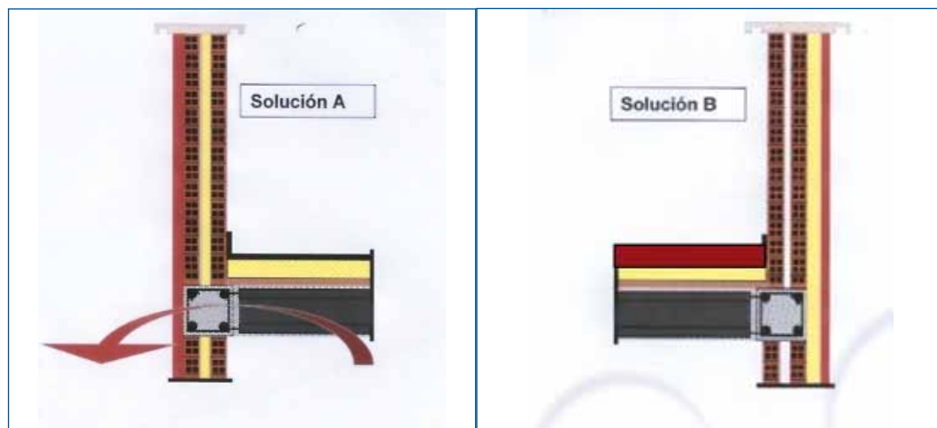
Cámara con aislamiento (A)
